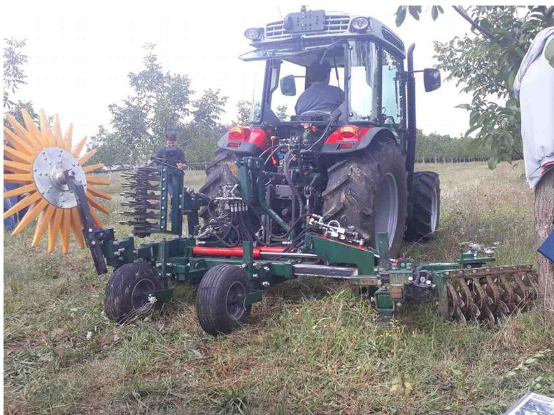
Ci dessus un porte outil ALM avec d'un coté une bineuse à disques et de l'autre une bineuse étoile Kress.
