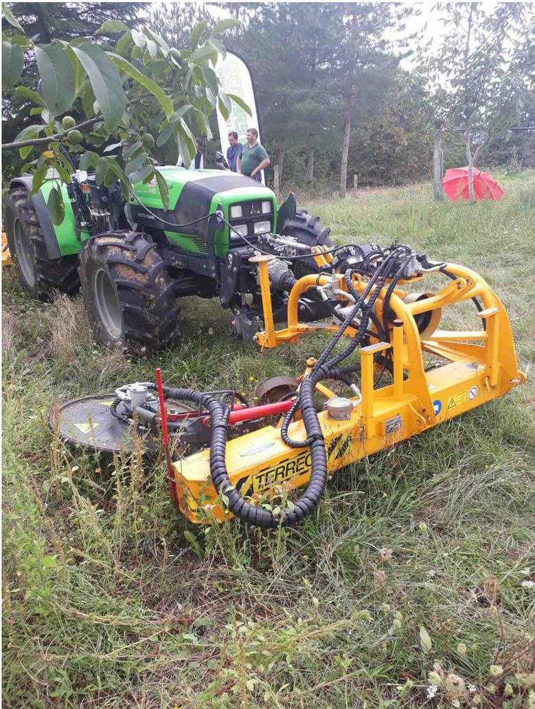
Ci dessus, Broyeur + satellite à cuillères Wanner en poste arrière, ci contre tondeuse en poste avant. Outils ne fonctionnant exclusivement qu'avec un centrale hydraulique. Le satellite arrière ne se monte pas sur un autre broyeur mais peut être utilisé avec un porte outils.
