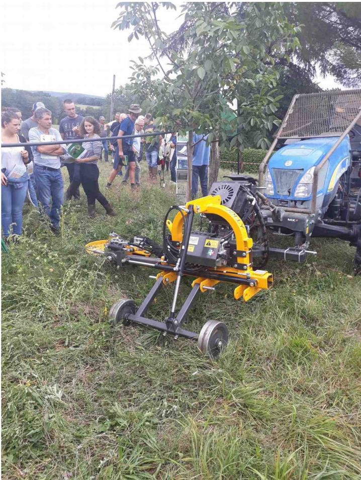
Tondeuse Jolly avec porte outil 1 demi coté en poste avant. Le porte outil simple ou double (2 demi cotés) est fait pour utiliser toute une gamme d'outils ne demandant pas plus 35l/min à la prise hydraulique. Commande par téléflexible ou joystick. Outil fonctionnel, de diamètre 60 ou 80cm avec 2 couteaux. Possibilité de travailler en poste avant ou arrière, et de substituer la tondeuse par un broyeur à cuillères.
